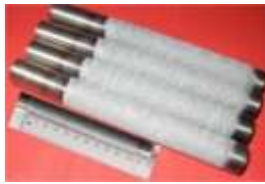
SiC clad layer on Zircaloy
